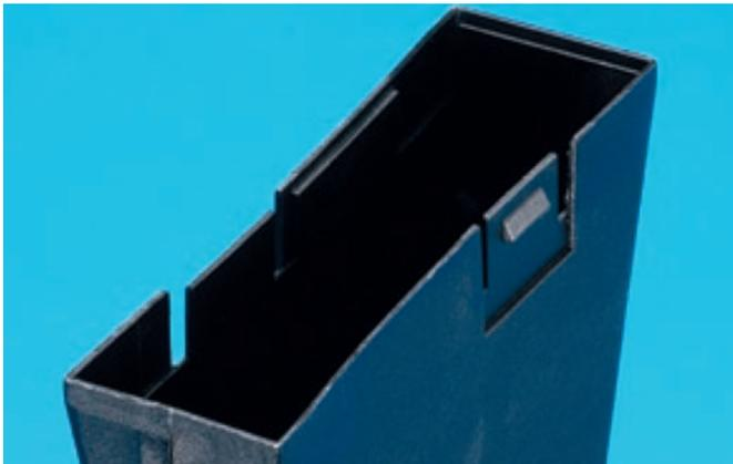
Verzug an einem kastenförmigen Bauteil
